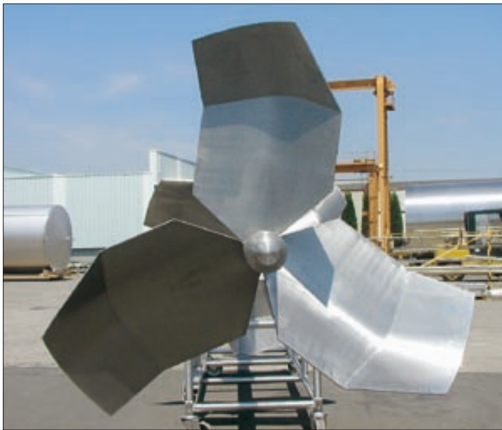
Hélice de l'agitateur HTPG4 breveté Pierre Guerin. Son rôle est de maintenir des liquides miscibles en suspension.
