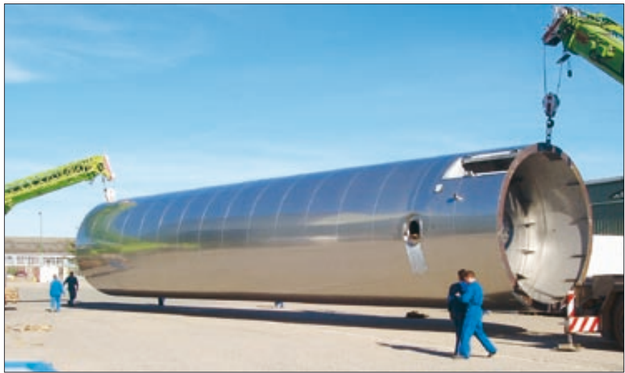
Destinée à l'industrie laitière, cette cuve de stockage de 300 000 litres, pour une hauteur de 24 m, est sortie récemment des ateliers Pierre Guérin.
