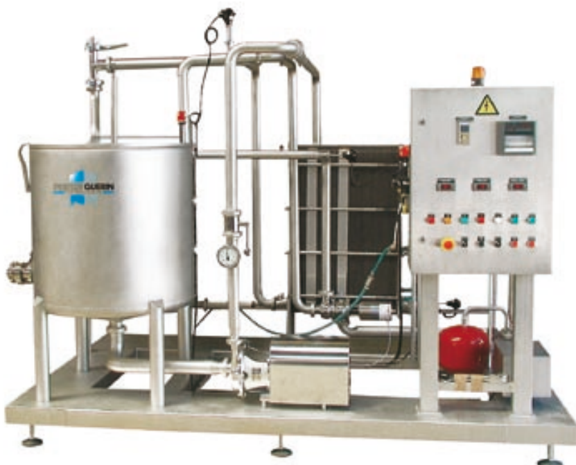
Plateforme de pasteurisation (débit 5 000 Litres/heure).
