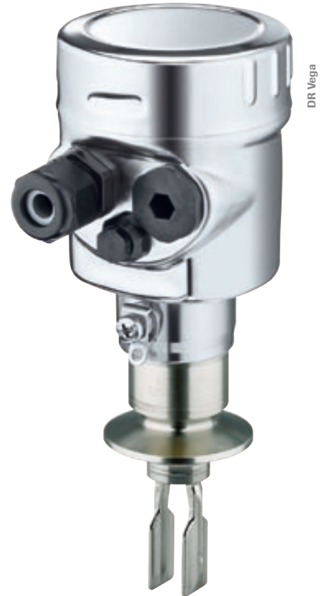
Les lames vibrantes du Vegaswing 61 sont entièrement soudées avec le raccord process, de façon à n'avoir aucun piège à bactéries.
