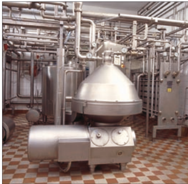
L'écémage est opéré avec un séparateur, appelé « écrémeuse » par les professionnels.
